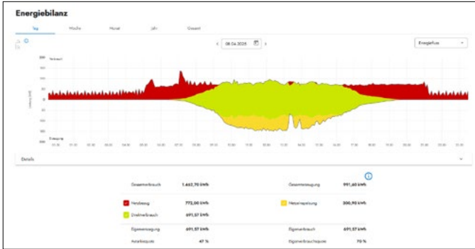
GST: Seit Inbetriebnahme im April 2025 deckt die neue Solarmalage einen wesentlichen Teil des Strombedarfs der GST und speist Überschüsse ins lokale Netz
